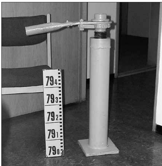
Einn af tjökkunum sem notaðir voru til að lyfta efri hæð kaupfélagsins.
