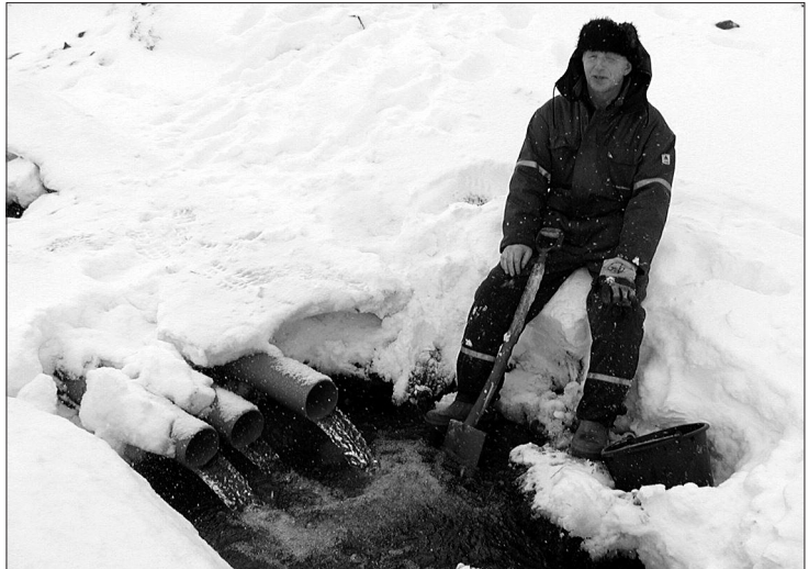
Geirfinnur verkstjóri áhaldahúss við rennslismælingar í Haflíðagili. Ljós.: Guðjón Elisson
